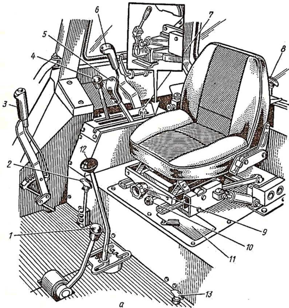
Рисунок 1. Органы управления в модернизированной кабине
